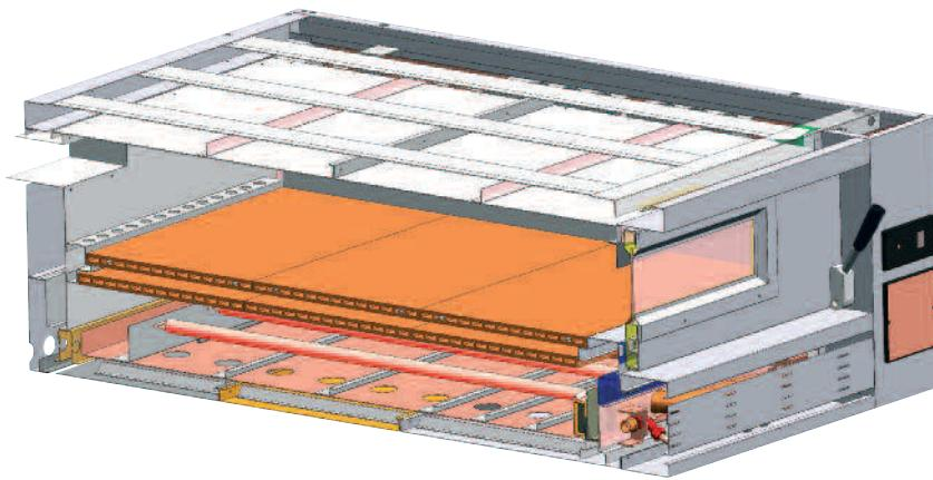
Uno speciale piano in refrattario a doppio strato con intercapedine d'aria distribuisce il calore sviluppato dal bruciatore garantendo così una perfetta uniformità di cottura.
